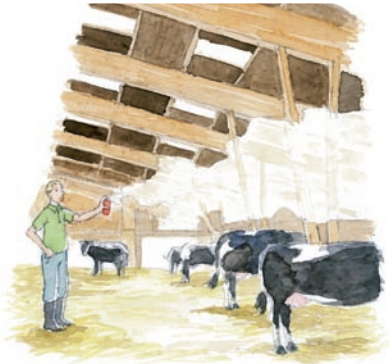
A l'aide d'un fumigène, un conseiller en bâtiment peut débusquer les courants d'air.
